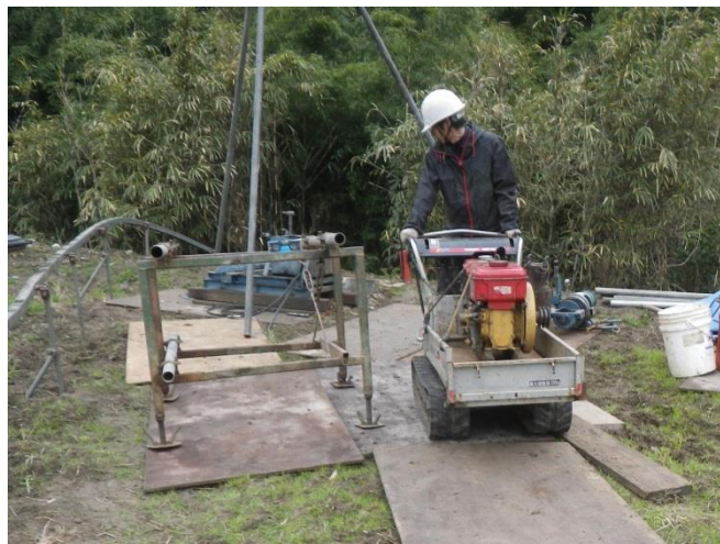
当社のクローラ運搬車（車体幅 80cm 程度）
